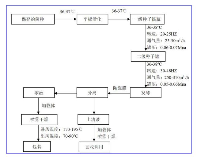
图 3-2 地衣芽孢杆菌饲料添加剂生产工艺流程图
